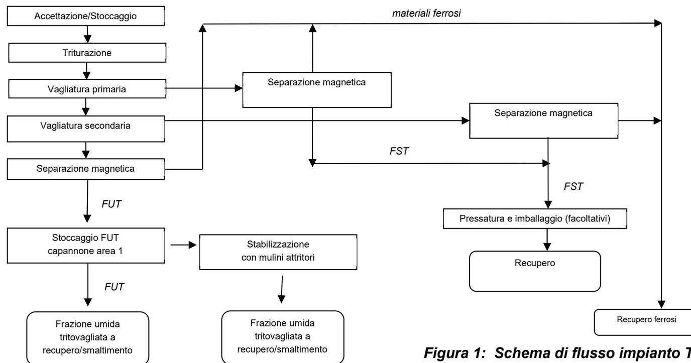
**Figura 1: Schema di flusso impianto TMB Tufino**
