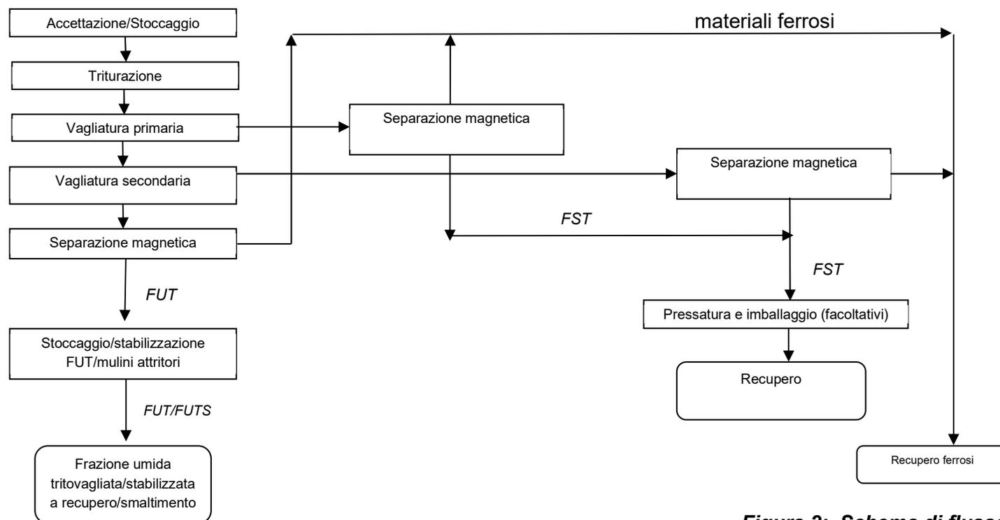
**Figura 2: Schema di flusso impianto TMB Giugliano**
