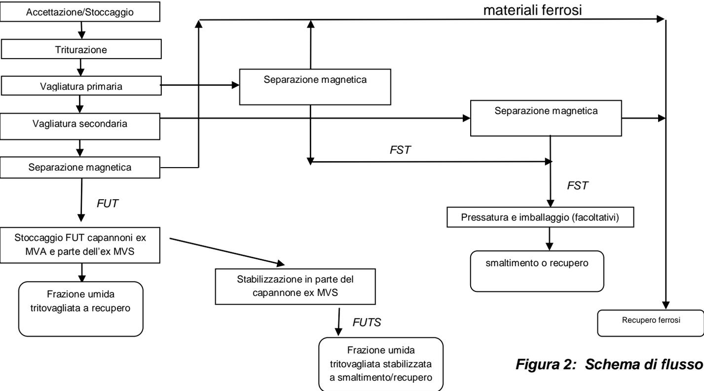
**Figura 2: Schema di flusso impianto STIR Giugliano**
