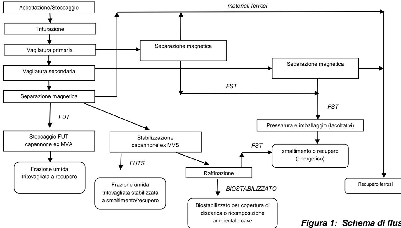
Figura 1: Schema di flusso impianto STIR Tufino
